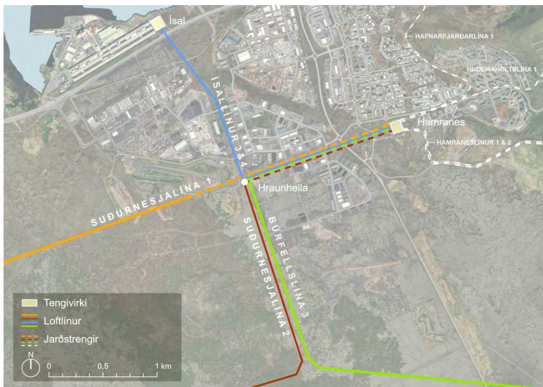
Skýringarmynd 24.4 Leiðbeinandi áfangaskipting raforkumannvirkja | Áfangi 2.
