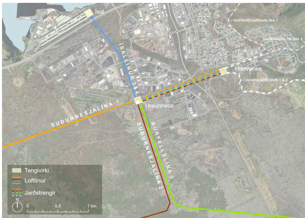
Skýringarmynd 24.5 Leiðbeinandi áfangaskipting raforkumannvirkja | Áfangi 3.
