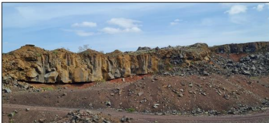
Mynd 4.1 Hraun ofan á gjalli í austurkanti Rauðamelsnámu. Stórstuðlað hraun vinstra megin á.
