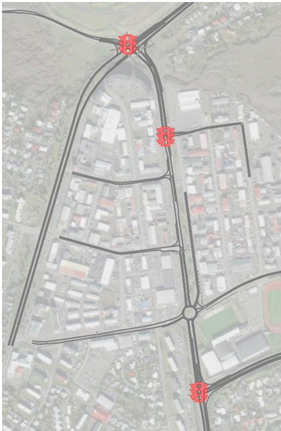
MYND 25 Uppsett umferðarhermilíkan af Fjarðarhrauni og aðliggjandi götum fyrir sviðsmyndir 1-3. Þrjú ljósaðstýrð gatnamót inn í hermun.
