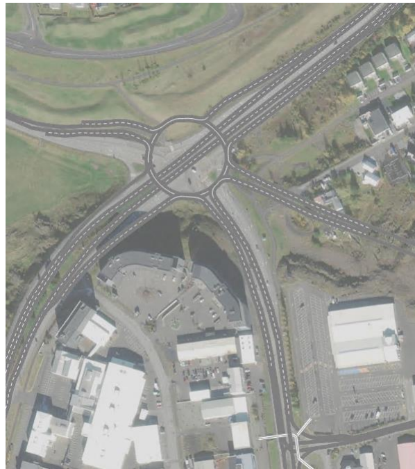
MYND 26 Útfærsla gatnamóta Hafnarfjarðarvegar-Reykjavíkurvegar-Fjarðarhrauns-Álftanesvegar fyrir sviðsmynd 4.
