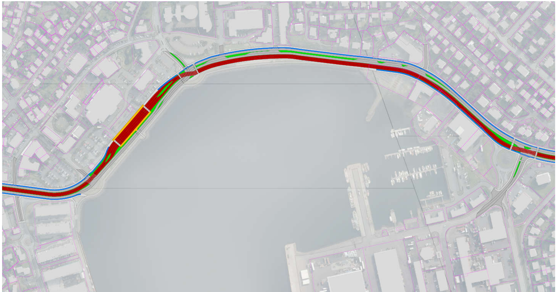
Mynd 16: Fjarðargata - Leggurinn frá Bæjartorgi að Flensborgartorgi. Dæmi um mögulega legu Borgarlínu í sérrými og með forgangi á gatnamótum og aðlögun gatnamóta. Hér er Borgarlína höfð til hliðar á kafla, en einnig er hægt að hafa hana í miðju alla leið.
