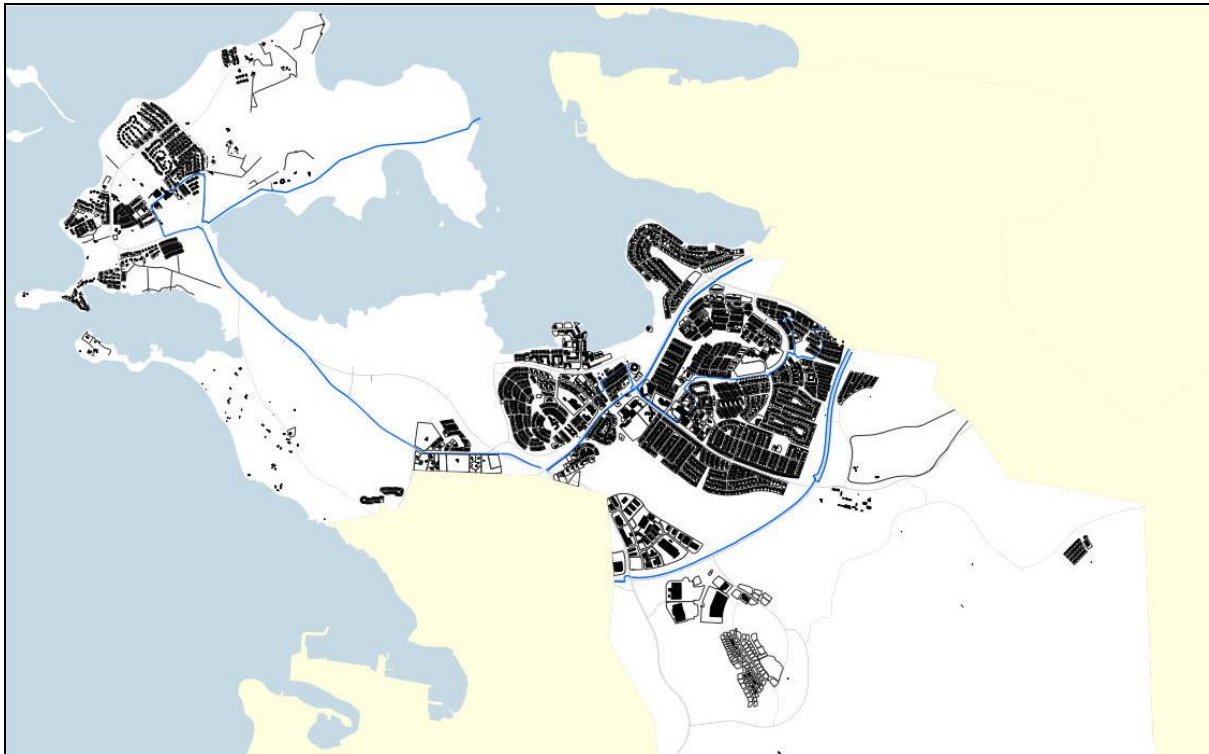
19. Mynd Skýringarmynd, ljósleiðari Mílu, stofnlagnir.
