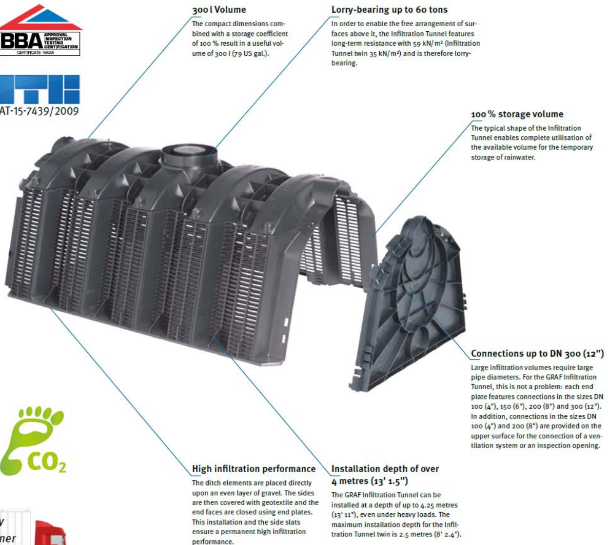
Mynd 3. Uppbygging á drengöngum sem kemur í einingum. Einingarnar eru opnar að neðanverðu og með götum í hliðunum til að tryggja að vatnið geti lekið áfram til umhverfisins
