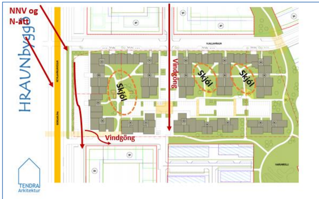
Mynd 5. Þegar vindur er N-stæðari finnur loftið sér farveg eftir opnum ás í gegn um hverfið.
