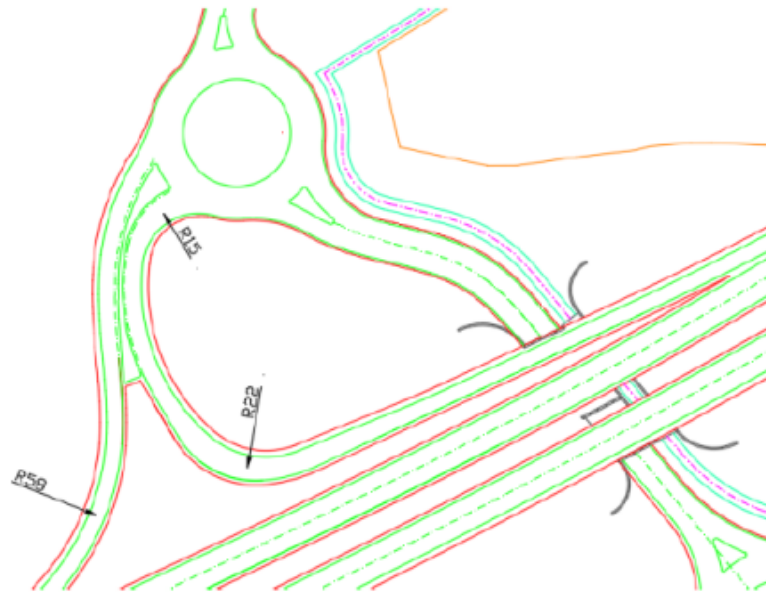
Mynd 2 Kostur B-93. Sjá má að beygjuradíusar eru talsvert undir lágmarkskröfum Vegagerðarinnar.
